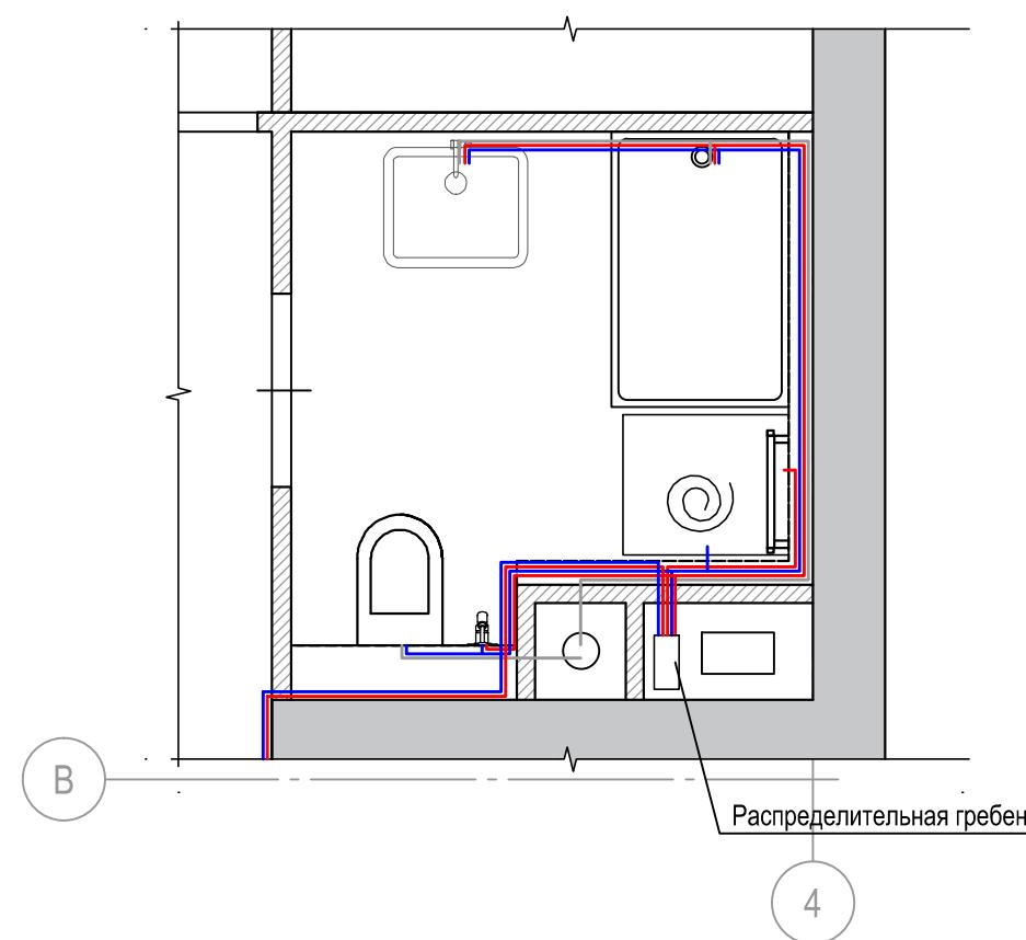
Фрагмент плана в осях А/2 с разводкой систем Т3, В1, К1
